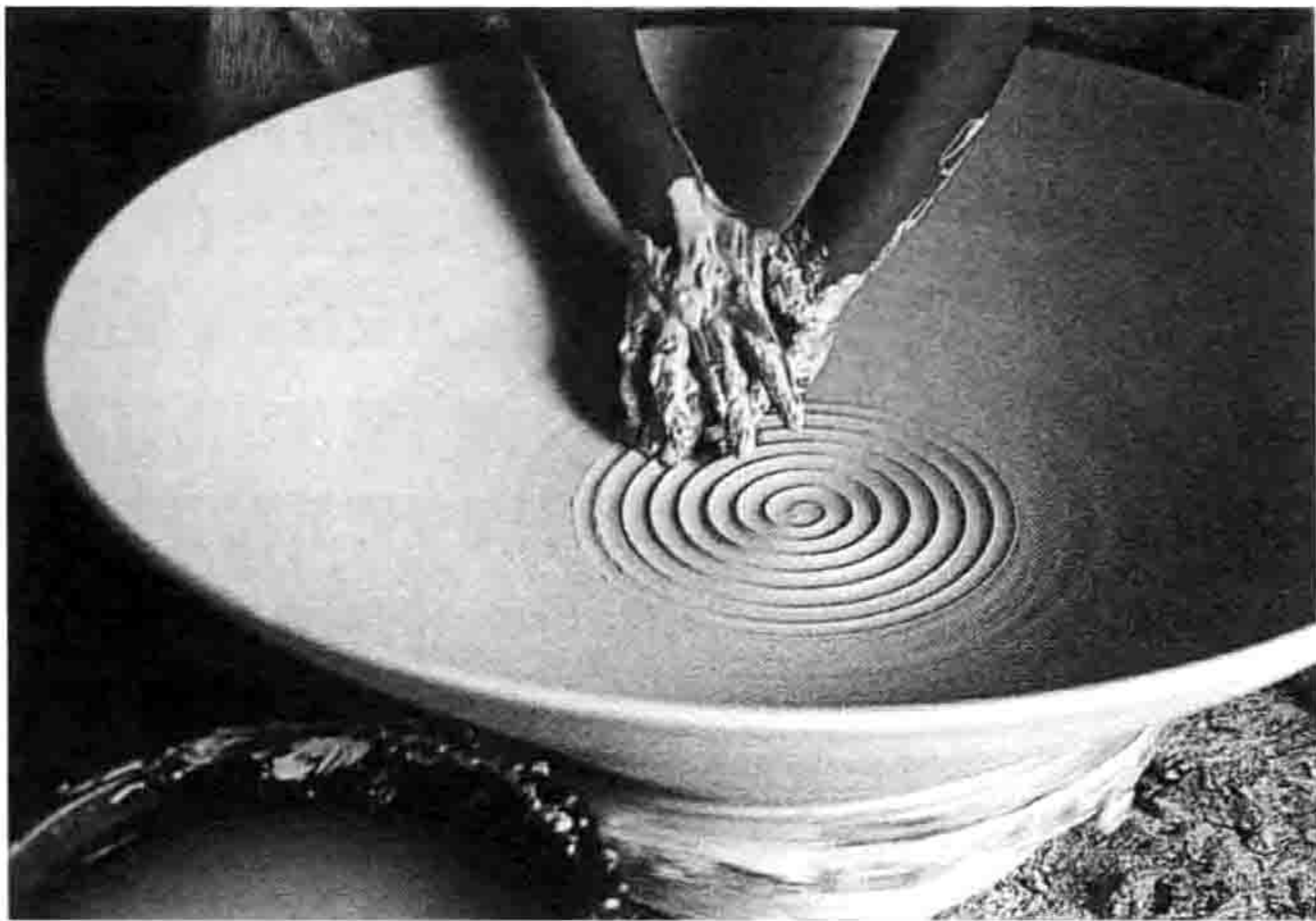
图 3-12 拉坯过程中手指压出螺旋纹
